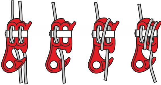
Grazie alla possibilità di invertire il cursore (fissato con una vite - tenuto in posizione da un magnete), può essere utilizzato comodamente anche dai mancini.
